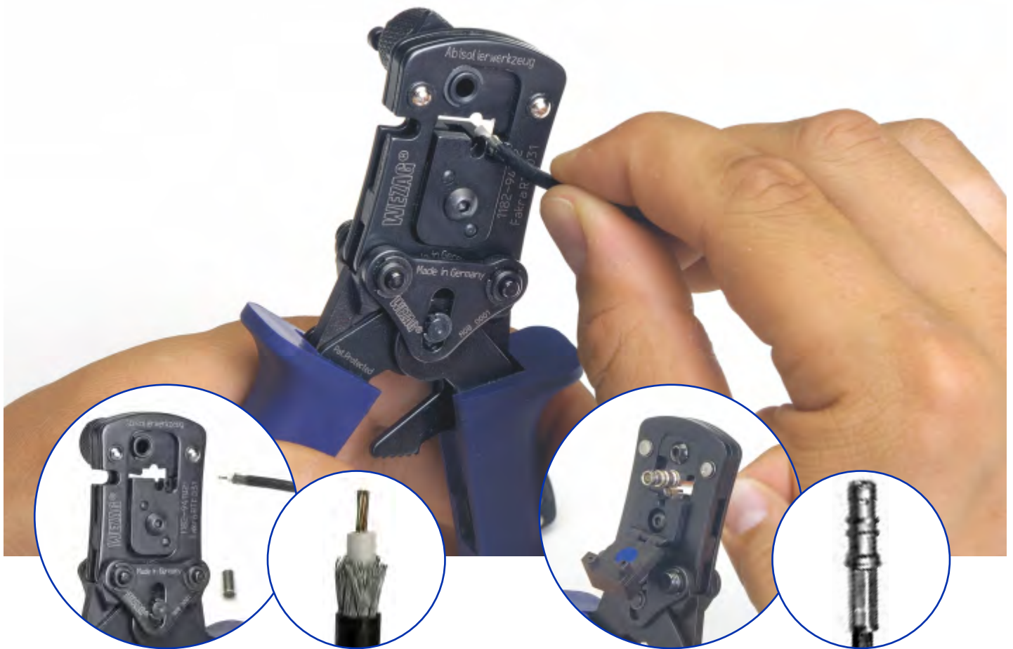
Abisolieren von abgeschirmten Leitungen Stripping of shielded cables Dénudage de câbles échantés
