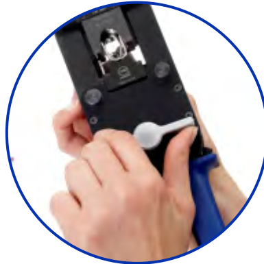
Vorspannen mit dem Schnellvorschub Pre-close with quick-advance system Pré-fermer avec système d'avance rapide
