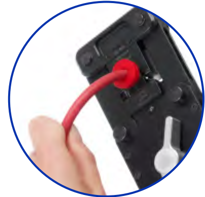
Kabel einlegen und Werkzeug schließen Insert cable and close the tool Insérer câble et fermer l'outil
