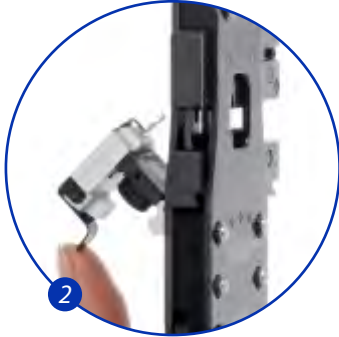
2 Kontakt in Positionierer einlegen Insert contact into locator Insérer le contact dans le positionneur
